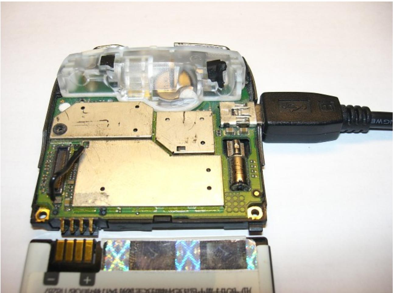
4) Удостоверьтесь, что телефон находится в режиме "S blank" с помощью Flash&Backup (вкладка FLASH-терминал, команда ENUM; если ТП сделан правильно **Flash&Backup** напишет "**ENUM = SBLANK**");
